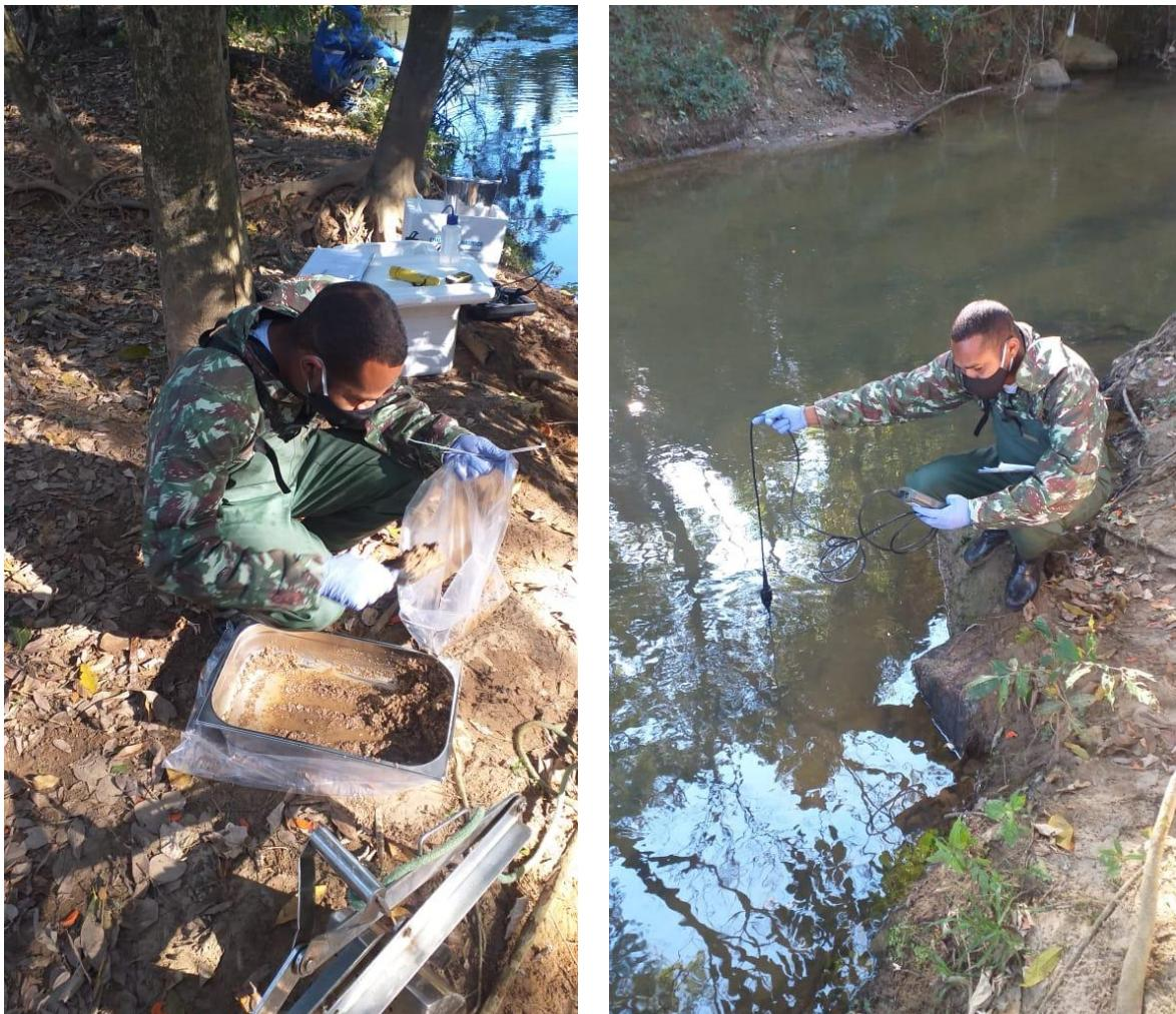
**Figura 1.** Análise das variáveis físicas e químicas do Ribeirão Piraí “in situ” pela equipe da Controle Analítico em julho de 2020. (Sonda multi-parâmetro Hanna modelo HI 98194). FOTO: Controle Analítico, 2020.
